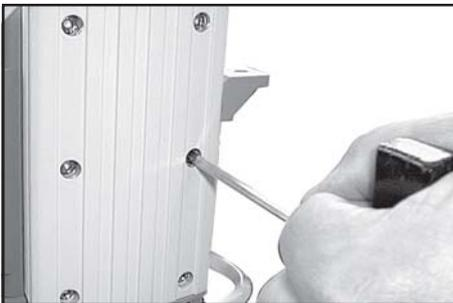
Die sechs Zylinderschrauben mit Innensechskant am Pumpenkopf lösen und das Gehäuseoberteil (Gehäusedeckel mit Gehäusedeckelinnenteil und Kopfdeckel) abnehmen.
