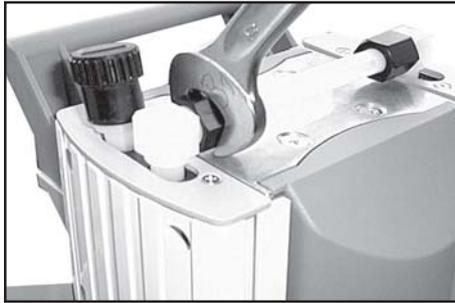
Schlauchansatz der Verschraubung mit Gabelschlüssel (SW 15) in den Schlauch hineindrehen.
