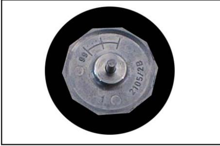
Neue Membrane zwischen Membranspannscheibe und Membranstützscheibe einlegen.
