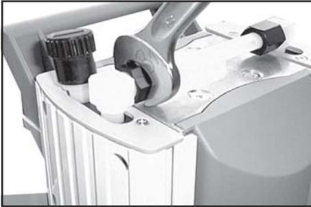
Mit Gabelschlüssel (SW 17) Überwurfmutter der Verschlauchung neben dem Gasballastventil lösen
