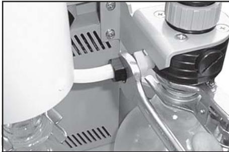
Schlauchansatz auf Verschraubung stecken.
