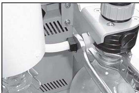
Mit Gabelschlüssel (SW 17) Überwurfmutter am Einlass der Pumpe lösen.
